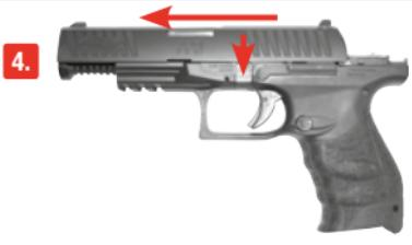
4. Pousser le levier de démontage des deux côtés vers le bas et retirer simultanément la culasse par l'avant.
