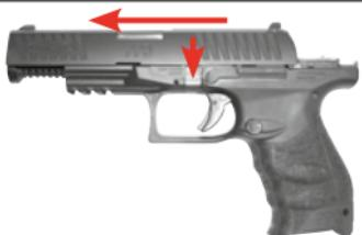
4. Zerlegehebel auf beiden Seiten runterdrücken, gleichzeitig den Schlitten nach vorne abziehen.
