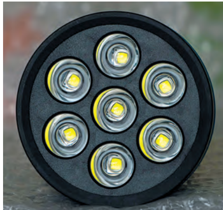
Sie machen das Licht – diese gelben, an eine Wasserwaage erinnernden Zellen sind die Leuchtdioden mit vorgeschalteten gelben Lumineszenz-Filtern der Lampen.
