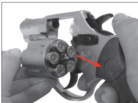
Вытолкните пустые гильзы с помощью экстрактора.
