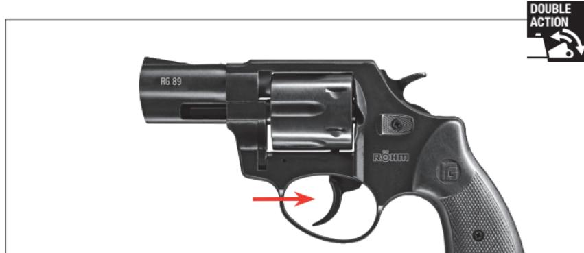
При нажатии на спусковой крючок взводится курок, а затем производится выстрел.
