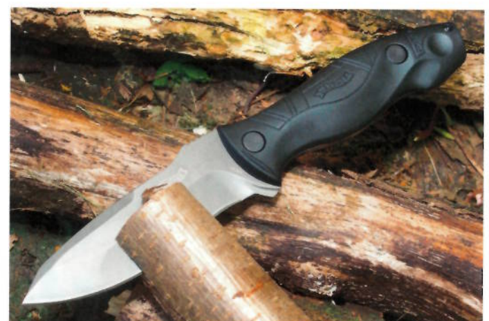
Arbeitstier: Auch vor dickerem Holz macht das FBK nicht halt. Deutlich zu sehen ist die Kombination von Hohl- und Flachschiess.
