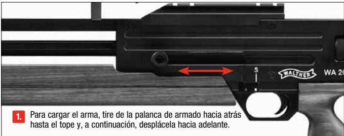
1. Para cargar el arma, tire de la palanca de armado hacia atrás hasta el tope y, a continuación, desplácela hacia adelante.
