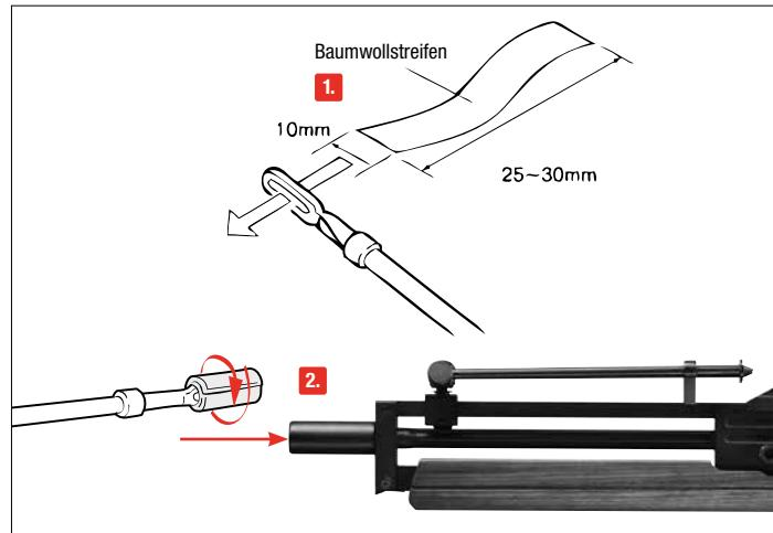
Sichern Sie die Waffe. Entnehmen Sie das Magazin. Nehmen Sie einen dünnen ca. 60 cm langen Stab. Wickeln Sie ein Stück Baumwolltuch um das Ende, benetzen Sie das Tuch mit etwas Waffen-Öl und reinigen Sie damit den Lauf.
